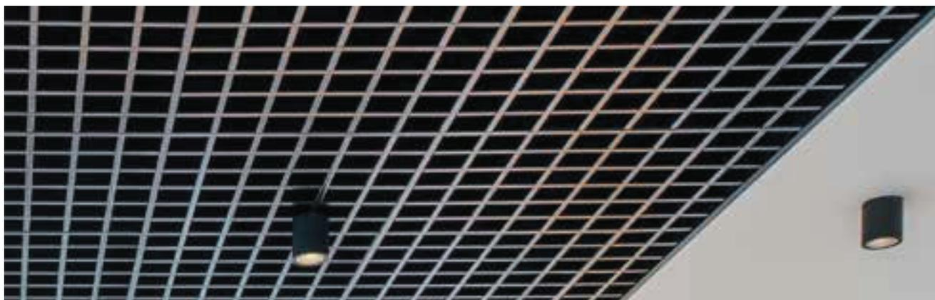
Le modèle SAS800 Trucell est un plafond décoratif ouvert destiné à la circulation d'air et l'extraction de fumée. Ce système de plafond métallique se compose d'une série de modules ouverts reposant sur l'ossature. Les modules de plafond peuvent s'intégrer à d'autres systèmes de plafond en métal ou plaques de plâtre.
